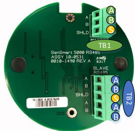
*Figure 4 SensePoint Modbus Option Wiring*
