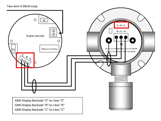
Figure 4-5: GASMAX EC Remote Sensor Wiring
