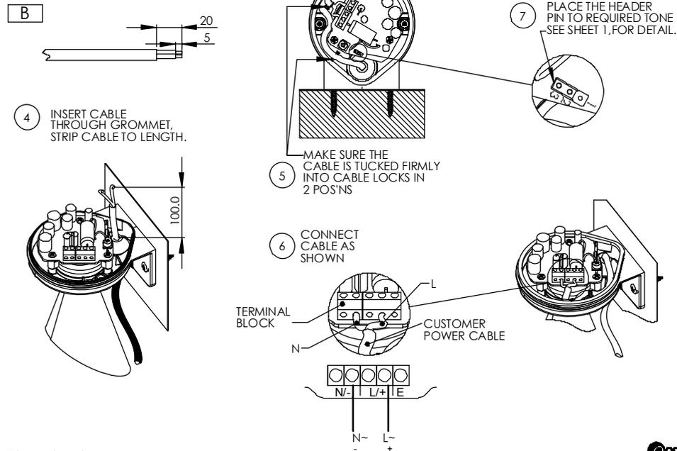
4 INSERT CABLE THROUGH GROMMET, STRIP CABLE TO LENGTH.
